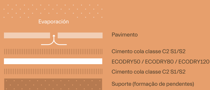
IMPERMEABILIZAÇÃO COM LÂMINAS ECODRY50 / ECODRY80 / ECODRY120
