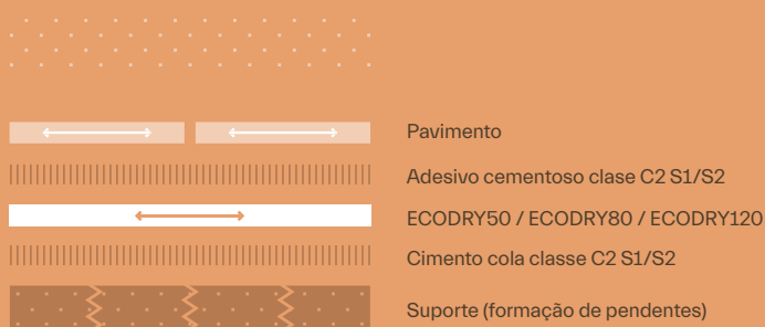
IMPERMEABILIZAÇÃO COM LÂMINAS ECODRY50 / ECODRY80 / ECODRY120
