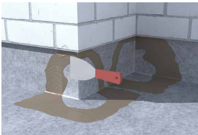
3. Voltar a aplicar o adesivo SEALPLUS nas juntas das peças ECODRY CORNERIN/CORNEROUT , efectuando uma dupla selagem.
